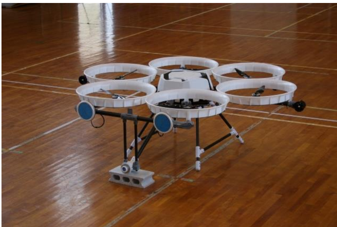
【写真 2】 建造物壁面検査用吸着型水素燃料電池ドローン
